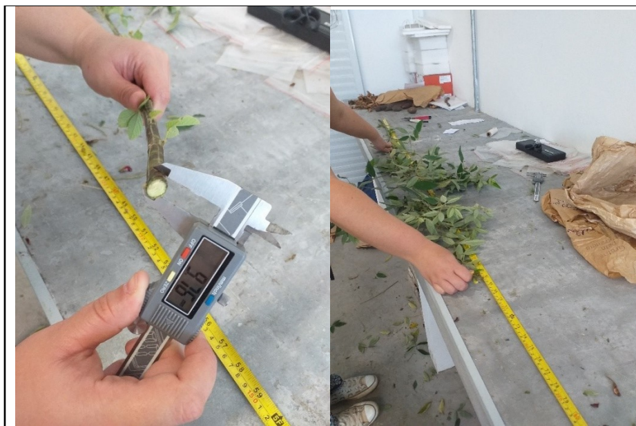
Figura 9. Mensuração do diâmetro na base e do comprimento do galho podado com o auxílio de um paquímetro digital e uma trena, respectivamente.
